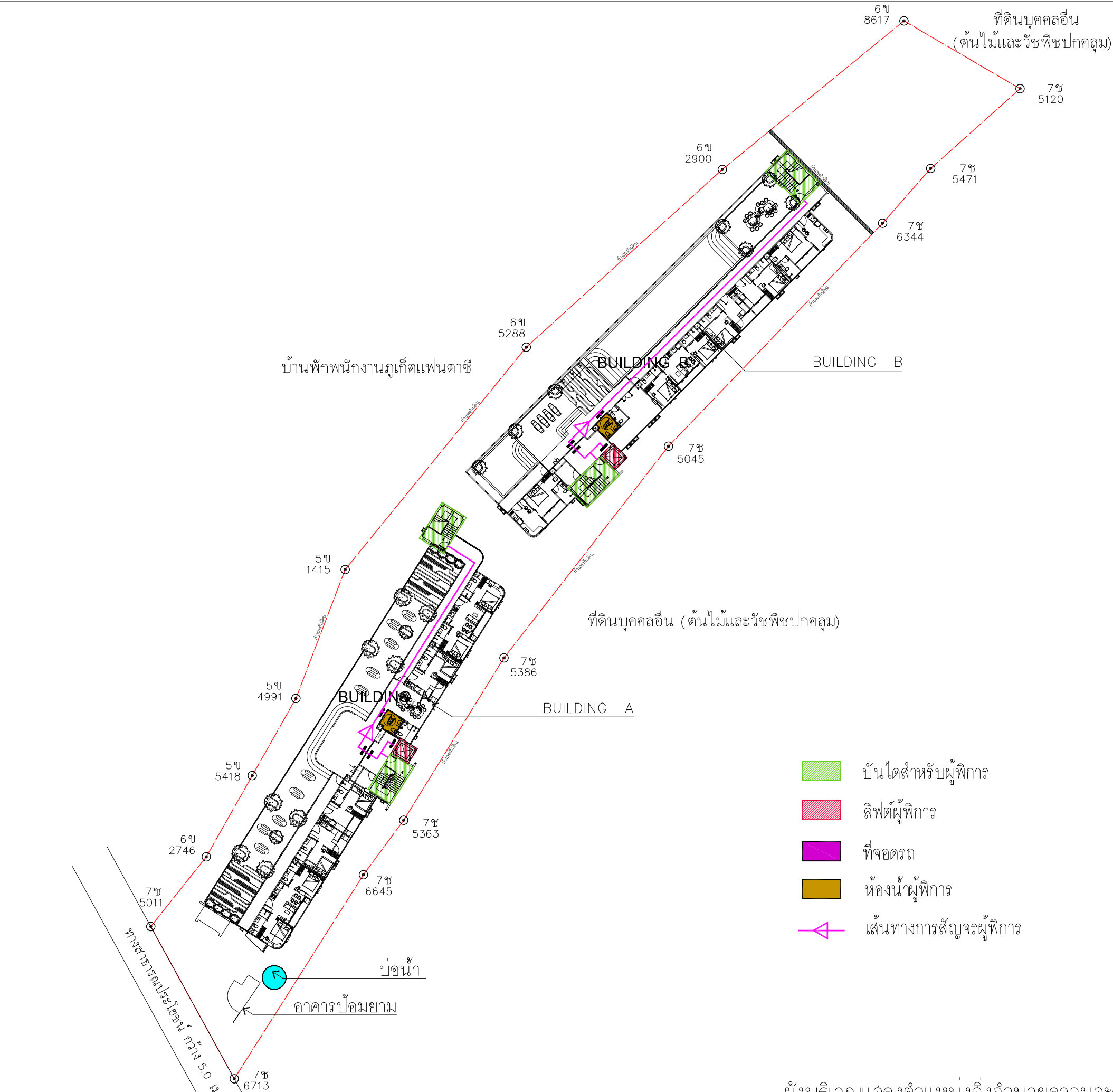
รูปที่ 2-17 ผังแสดงตำแหน่งสิ่งอำนวยความสะดวกสำหรับผู้พิการหรือทุพพลภาพ และคนชรา ชั้นที่ 8
